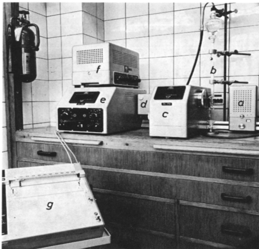
Fig. 3. Gesamtansicht der Messanordnung. a = Leuchte; b = Trennsäule; c = Monochromator; d = Empfänger; e = Anzeigegerät; f = Transmissions-Extinktions-Wandler; g = Schreiber.
